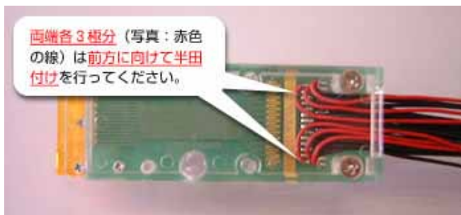
※写真は S Body (19mm 幅) ですが M Body (24mm 幅) も同様に行ってください。 また、撮影用に配線押さえゴムは外してあります。
